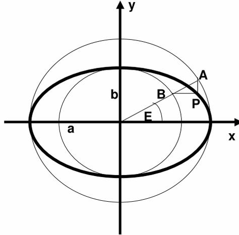
Figure 1: La costruzione dell'ellisse di semiassi assegnati.
