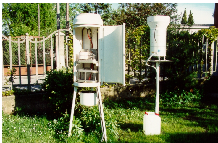
Figura 2.1: Immagine del pluviometro elettronico Micros (sulla destra) e del pluviografo meccanico (in primo piano) relativi alla stazione meteo di Varese CGP (Archivio CGP)
