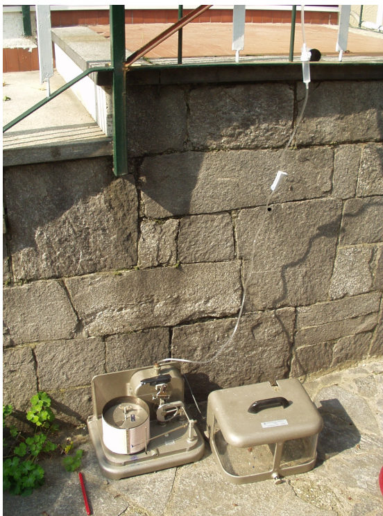
Figura 2.3: Immagine della taratura del pluviografo meccanico, effettuata usando un contenitore per flebo come riferimento (Archivio CGP)
