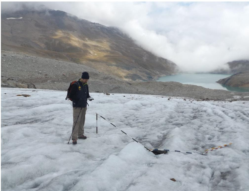
**Figura 28. Misura del bilancio di massa del ghiacciaio di Hohnsand il 16 settembre 2014 presso la palina ablatometrica non lontano dalla fronte a 2555m di quota. Dal 29 luglio 2011 la perdita di spessore è stata superiore a 10 metri!**
